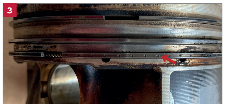
Aktuelle Konstruktion von Ölabbstreifringen. Sie sind auf den Einsatz von hochwertigen dünnen Motorölen konzipiert. Sinkt die Ölqualität verkoken diese Kapillarbohrungen besonders schnell.
