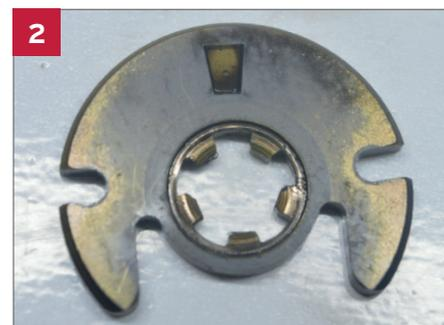
Durch Abgasgegendruck eingelaufenes Axiallager
