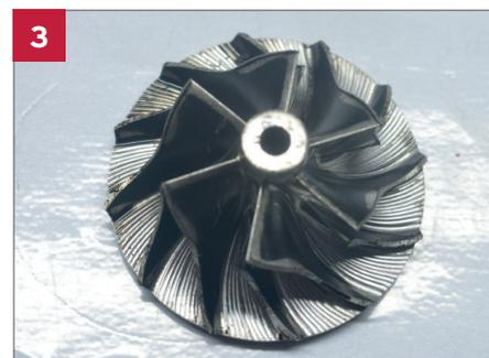
Das Verdichterrad ist im Gehäuse angelaufen, beim ersten Kontakt pfeift es, später bricht die Welle durch die Bremswirkung
