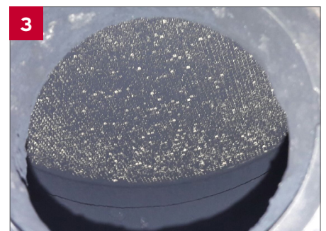
Schwierig wird die Identifikation bei einem verschmutzten Filter. Hier wurde ein Abgasgedrueck von 0,8 bar gemessen (max. 0,3 bar zulässig)
