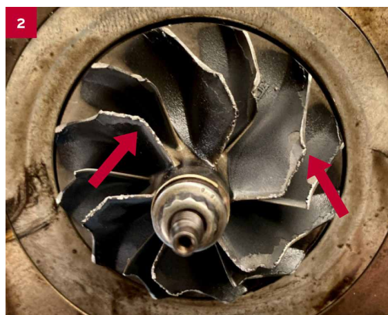
Das Verdichterrad ist an den Gaseintrittskanten beschädigt. Ein Stück verklemmte sich zwischen Verdichterrad und -Gehäuse und verursachte durch die extreme Rotationskraft das Verbiegen der Turbinenwelle.
